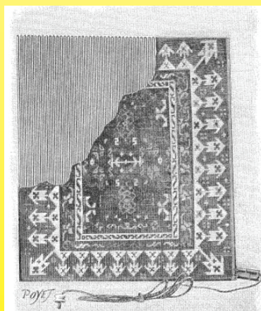
Vista interna del tappeto riscaldante, in alto a sinistra - fili attraversati dalla corrente, in basso a destra - presa di corrente (1904, La Nature, Ultimheat Collection)
