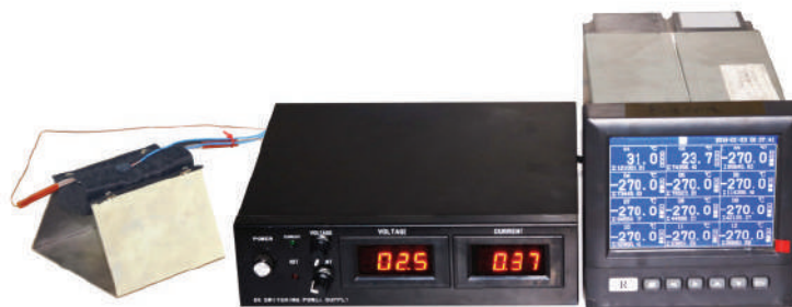
Apparecchiatura per la misurazione della temperatura superficiale in funzione della superficie W/cm^2 del riscaldatore della coperta o del riscaldatore a mantello
