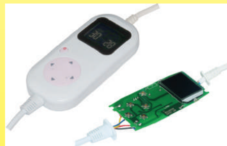
2019 Unità di controllo per coperte riscaldanti termoregolate con display digitale tramite sonda a termistore incorporata nella zona riscaldata (Ultimheat Collection).
